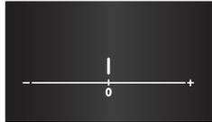
Se o valor de CO2 detectado, difere dos valores indicados na tabela A, pressione OK. O display, após alguns segundos, mostra um barra de ajustamento.
