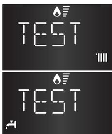
No display visualiza-se **TEST** e o símbolo (máxima potencia aquecimento).
